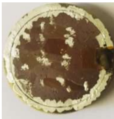
Рис. 2.2. Фотография образцов, подготовленных для исследований электронно-зондовыми методами.
