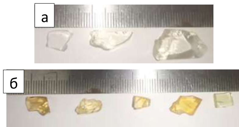
Рис. 2.1. Фотографии стекол: а) Si-Al-х, б) Si-Bi-х.
